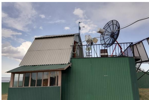
Рисунок 3.16 – Фотография экспериментальной установки для наблюдения за серебристыми облаками. Приборы смонтированы в с. Преображенка (Забайкальский край)
