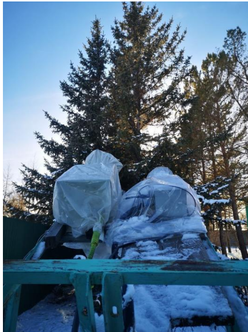
Рисунок 3.18 – Радиометрические приемники на длину волн 2,3 см и 5,6 см для исследования собственного теплового излучения елей
