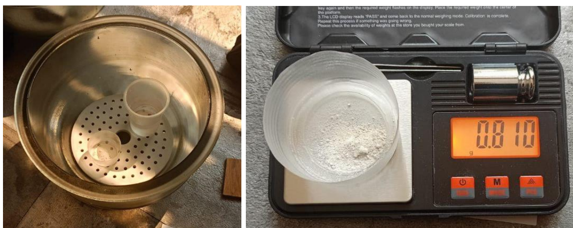
Рисунок 3.3 – Фотография процесса увлажнения и взвешивания образцов
