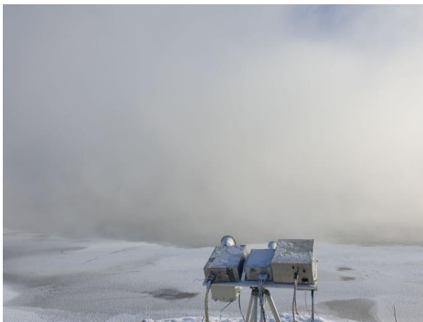
Рисунок 3.12 – Фотография радиометрического комплекса в один из моментов проведения измерений собственного теплового излучения переохлажденного водного аэрозоля
