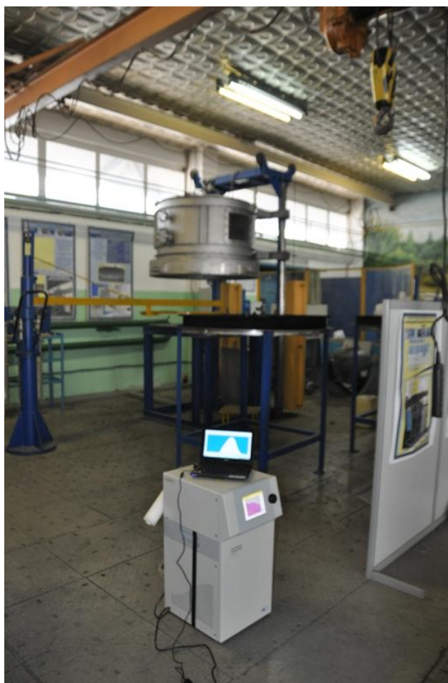
Рисунок 25 – Проведение анализа содержания НЧ в воздухе в производственном помещении объекта nanoиндустрии с помощью спектрометра-классификатора частиц с высокой мобильностью FMPS модель 3091
