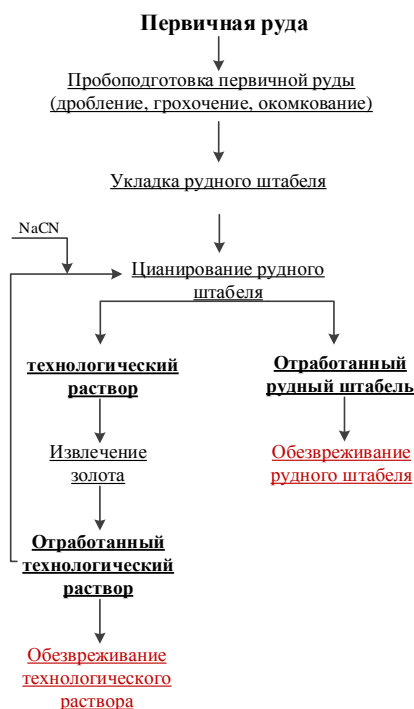
Рисунок 1.2. Схема технологического процесса извлечения золота методом КВ
