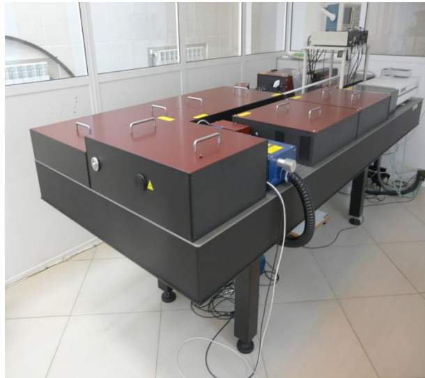
Рисунок 2.3 – Фемтосекундный лазерный комплекс Института сильноточной электроники СО РАН (г. Томск).
