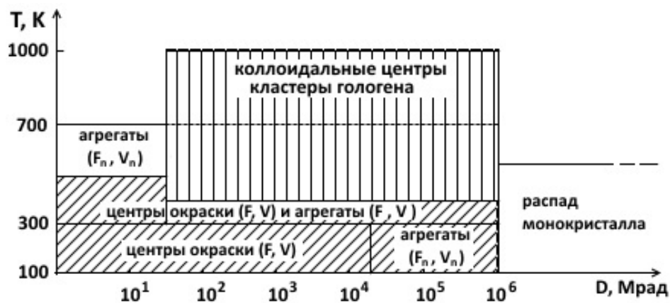
Рисунок 2.30 – Температурные и дозовые области агрегации электронных и дырочных продуктов радиолиза в кристаллах LiF [267].
