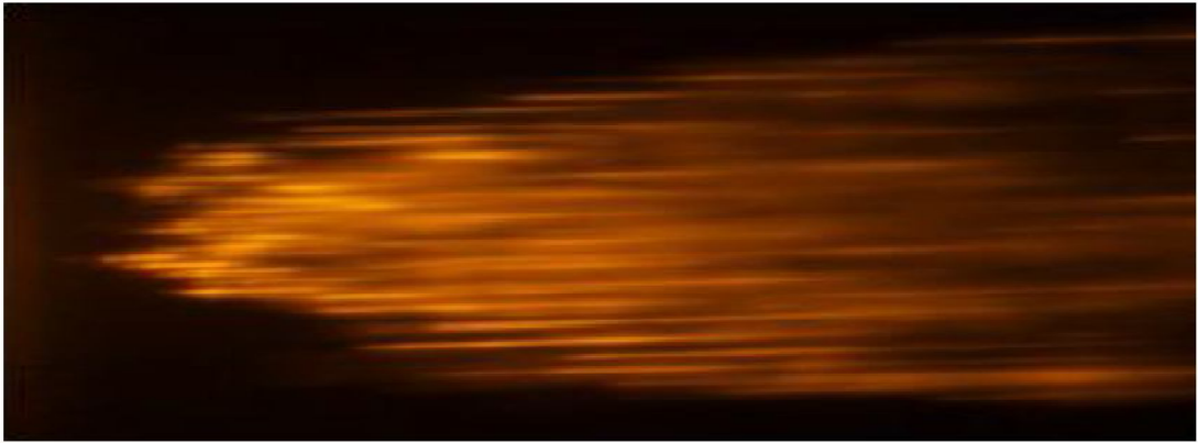
Рисунок 2.9 – Картина распределения интенсивности фотолюминесценции дефектов в головной части канала, наведенного одиночным импульсом.
