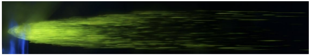
Рисунок 3.9 – Картина распределения интенсивности фотолюминесценции дефектов в одиночном канале, наведенном серией импульсов. Диаметр канала в области его максимума достигает \sim 1,8 мм.
