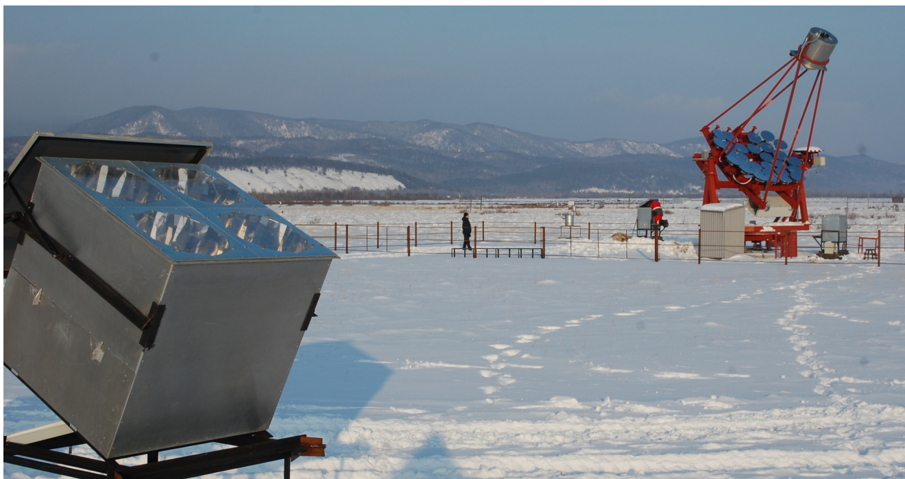
Рисунок 2.6 — Детекторы черенковского излучения ШАЛ от гамма-квантов. На переднем плане: черенковский контейнер установки HiSCORE. На заднем: телескоп IACT.
