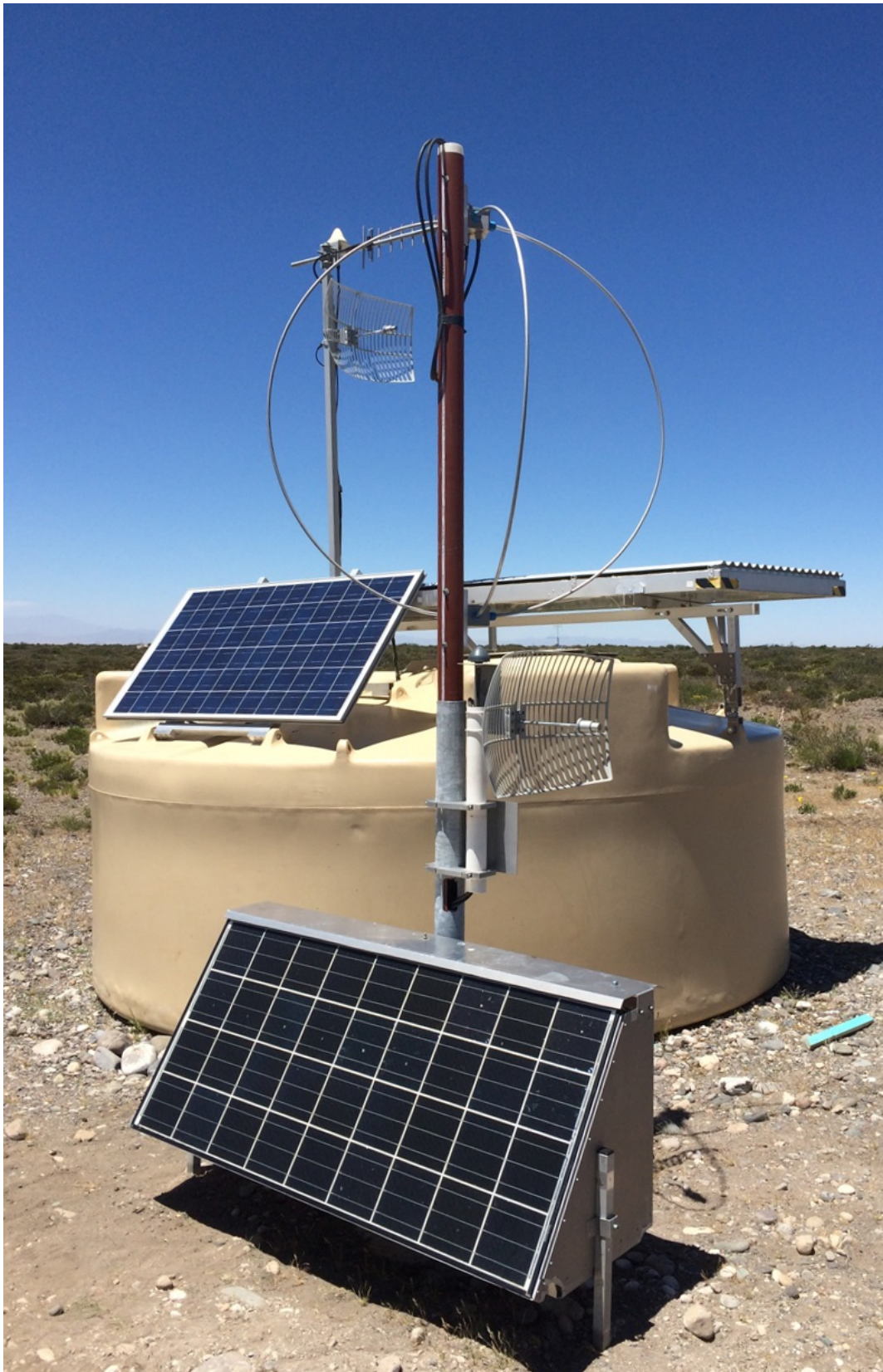
Рисунок 1.9 — Антенная станция AERA. На заднем плане - детектор частиц на базе бака с водой.
