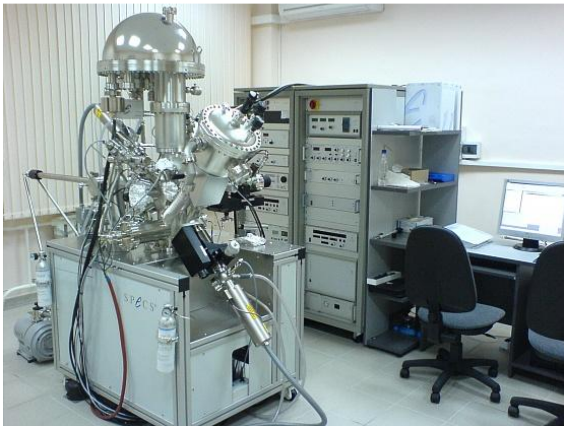
Рисунок 2.1. Фотоэлектронный спектрометр SPECS
