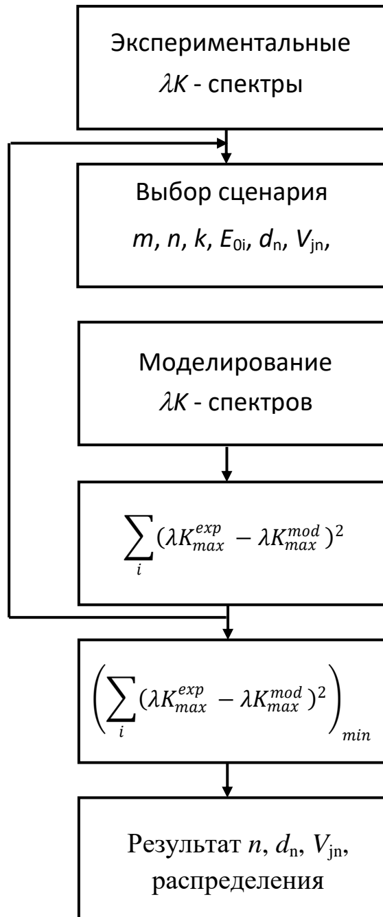
Рисунок 4.22. Алгоритм расчета профиля концентрации
