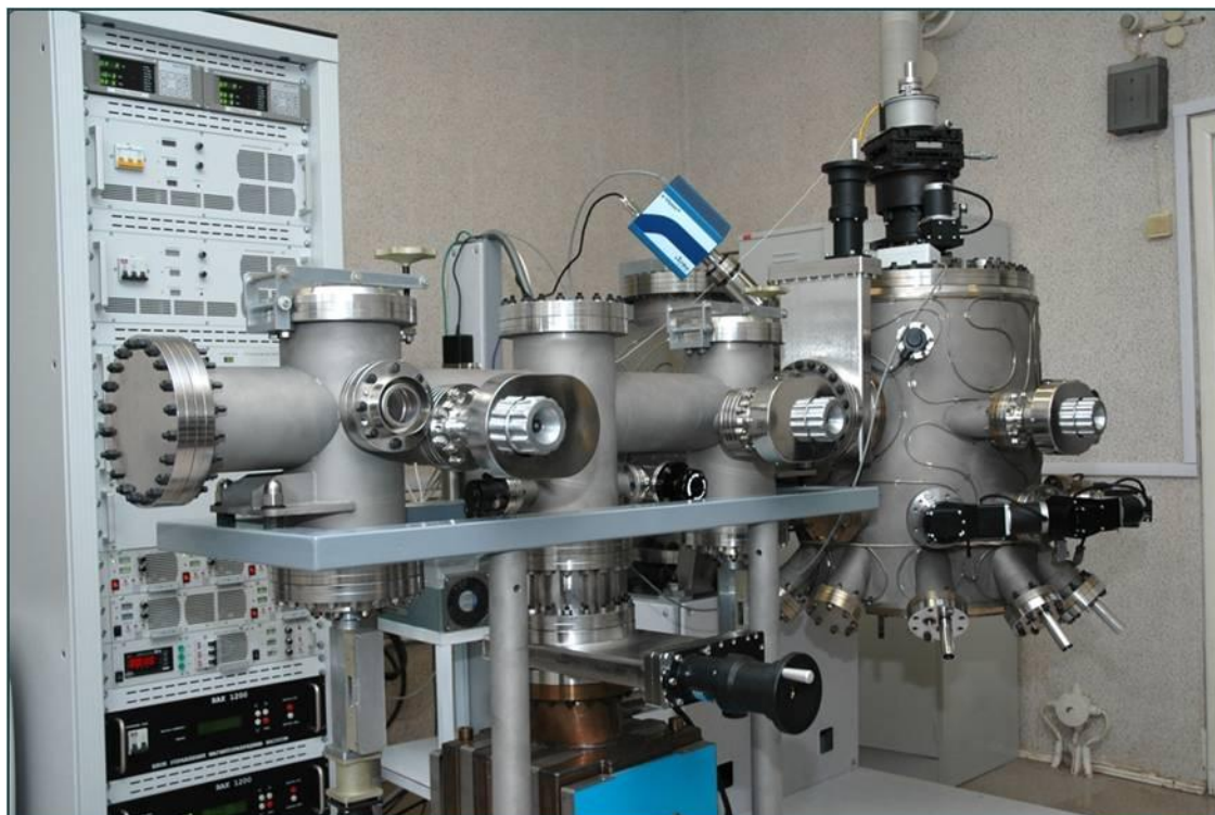
Рисунок 2.4. Технологический комплекс для молекулярно-лучевой эпитаксии «КАТУНЬ 100»
