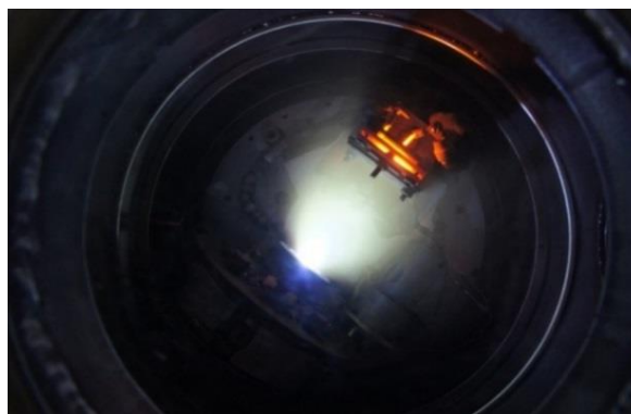
Рисунок 2.2 – Процесс ИЛО тонкой плёнки Zn_{1-x}Co_xO_y при плотности энергии излучения на мишени 4,2 Дж/см 2
