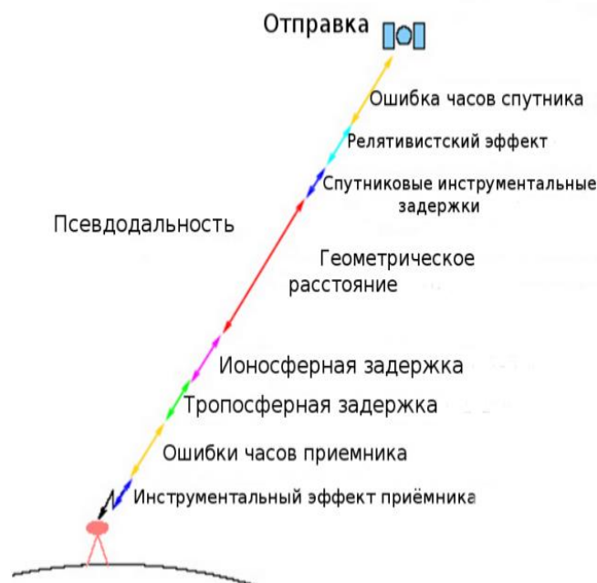
Рисунок 2 — Схематическое описание процесса возникновения ошибок измерений ГНСС. Взято из [58]
