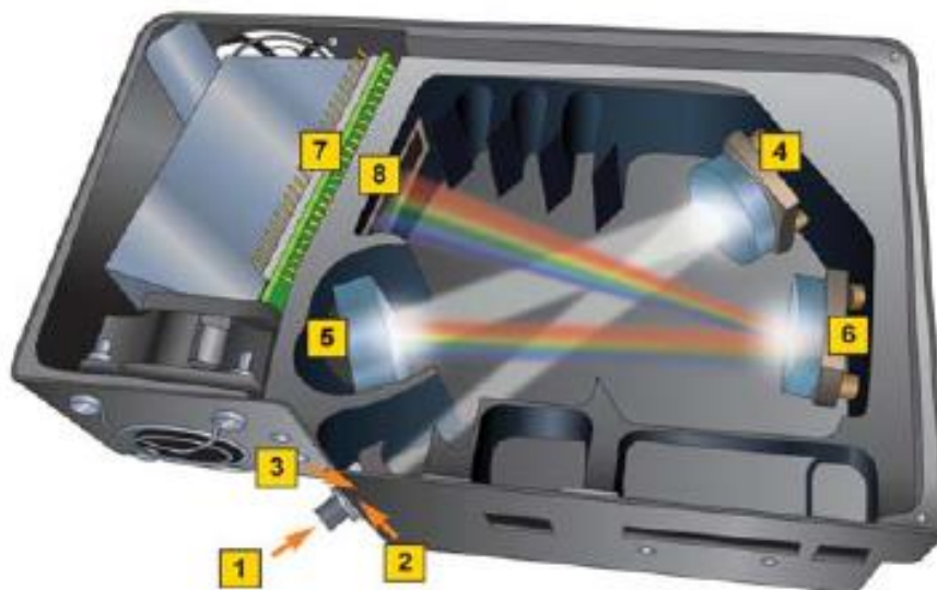
Рисунок 2.7 — Оптическая схема спектрометра Ocean Optics QE65000 [87] (1 - Разъем SMA 905, 2 - Фиксированная входная щель, 3 - Оптический фильтр, 4 - Коллимирующее зеркало, 5 - Дифракционная решетка, 6 - Фокусирующее зеркало, 7 - Детектор с термоэлектрическим охлаждением, 8 - Переменный фильтр высших порядков OFLV)
