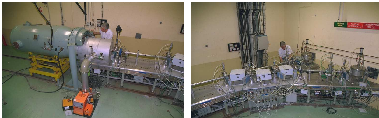
Рис.2.4. Акселератор Ван де Граафа (2.5 МэВ, 200 \mu А).
