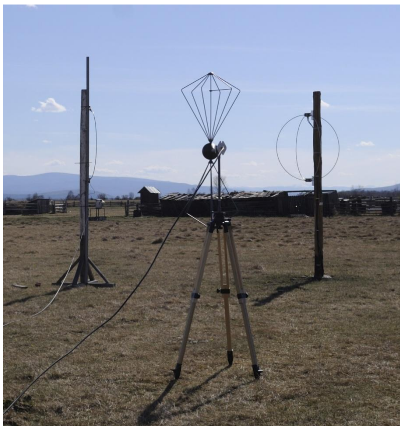
Рис. 2.21. Измерение шумов с помощью измерительной антенны НК116 с сертифицированной характеристикой в диапазоне 20 – 300 МГц.
