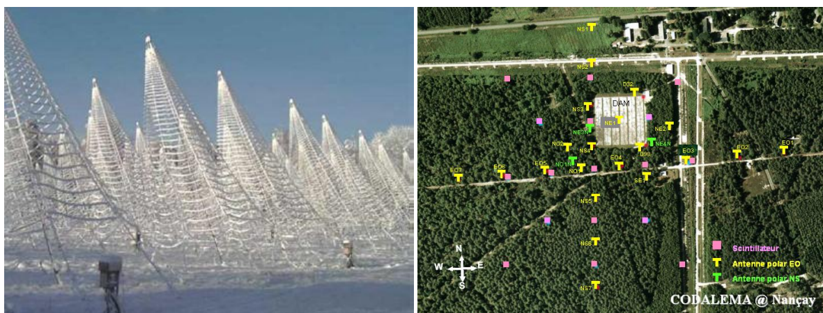
Рис. 1.14. Пример антенной системы CODALEMA. Слева: вид антенн CODALEMA. Справа: схема расположения антенн CODALEMA.
