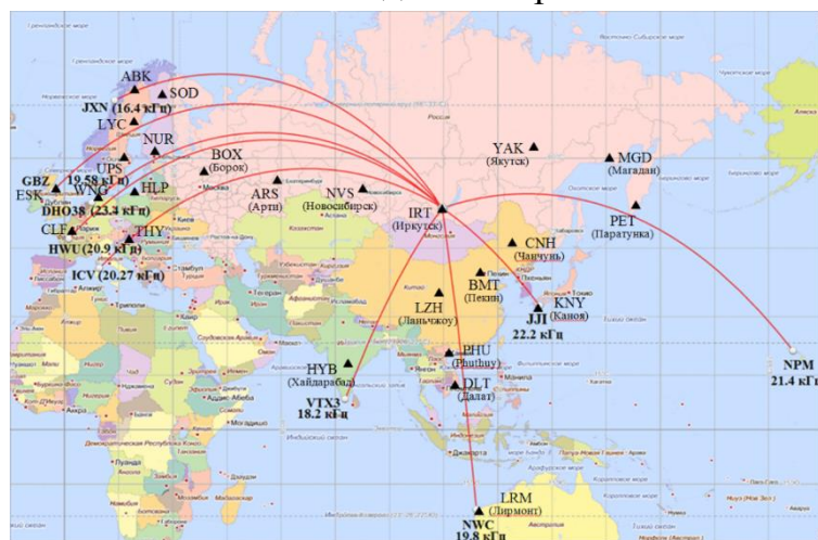
Рисунок 1 – Трассы распространения СДВ радиосигналов, выбранных для приема
