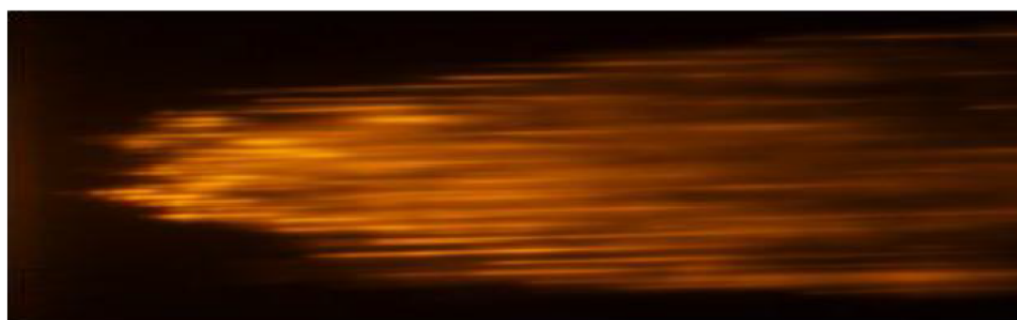
Рисунок 1 – Картина распределения интенсивности фотолюминесценции дефектов в головной части канала, наведенного одиночным импульсом.
