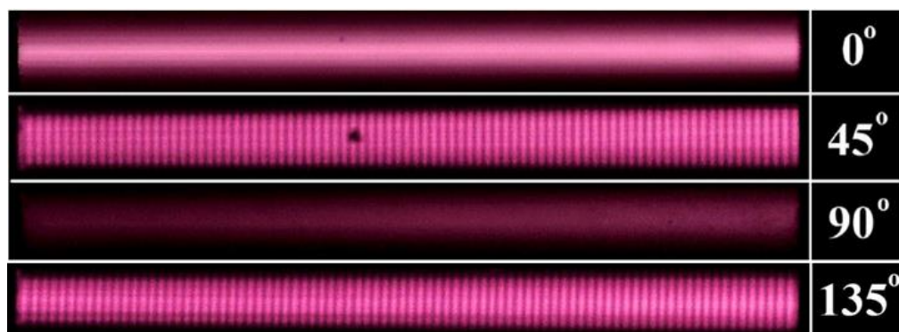
Рис. 1 Явление пространственной модуляции интенсивности люминесценции анизотропного кристалла. Показаны изображения люминесцирующих каналов при различных ориентациях электрического вектора возбуждающего лазерного излучения относительно оптической оси кристалла (0, 45, 90 и 135 градусов, соответственно)
